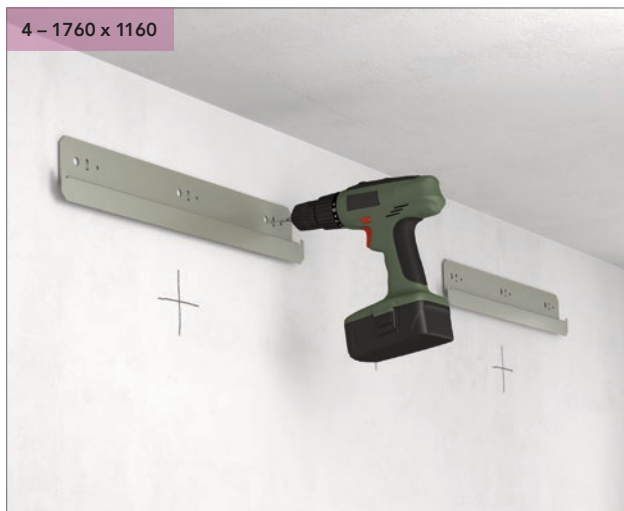
Boor de gaten en installeer het wandbevestigingsprofiel.
